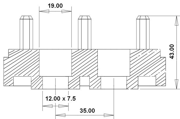
**MORSETTIERA REALIZZATA IN RESINA FENOLICA CERTIFICATA U.L. E IN RESINA POLIESTERE TERMOINDURENTE B.M.C. CERTIFICATA U.L.**
